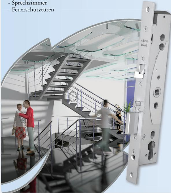
Die Schösser **ABLOY® EL560** und **ABLOY® EL561** werden für Holz- und Metalltüren, EL460 und EL461 für schmale Profiltüren verwendet. Das Schloss EL560 oder EL460 mit geteilter Nuss wird gewählt, wenn der Austritt mittels Drücker benötigt wird. Das Schloss EL561 oder EL461 wird gewählt, wenn sowohl Zugang als auch Ausgang elektrisch gesteuert werden.
