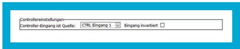
*Controller Eingang ist Quelle* bestimmt den Eingang des Controllers und dieser kann auch bei Bedarf invertiert werden.
