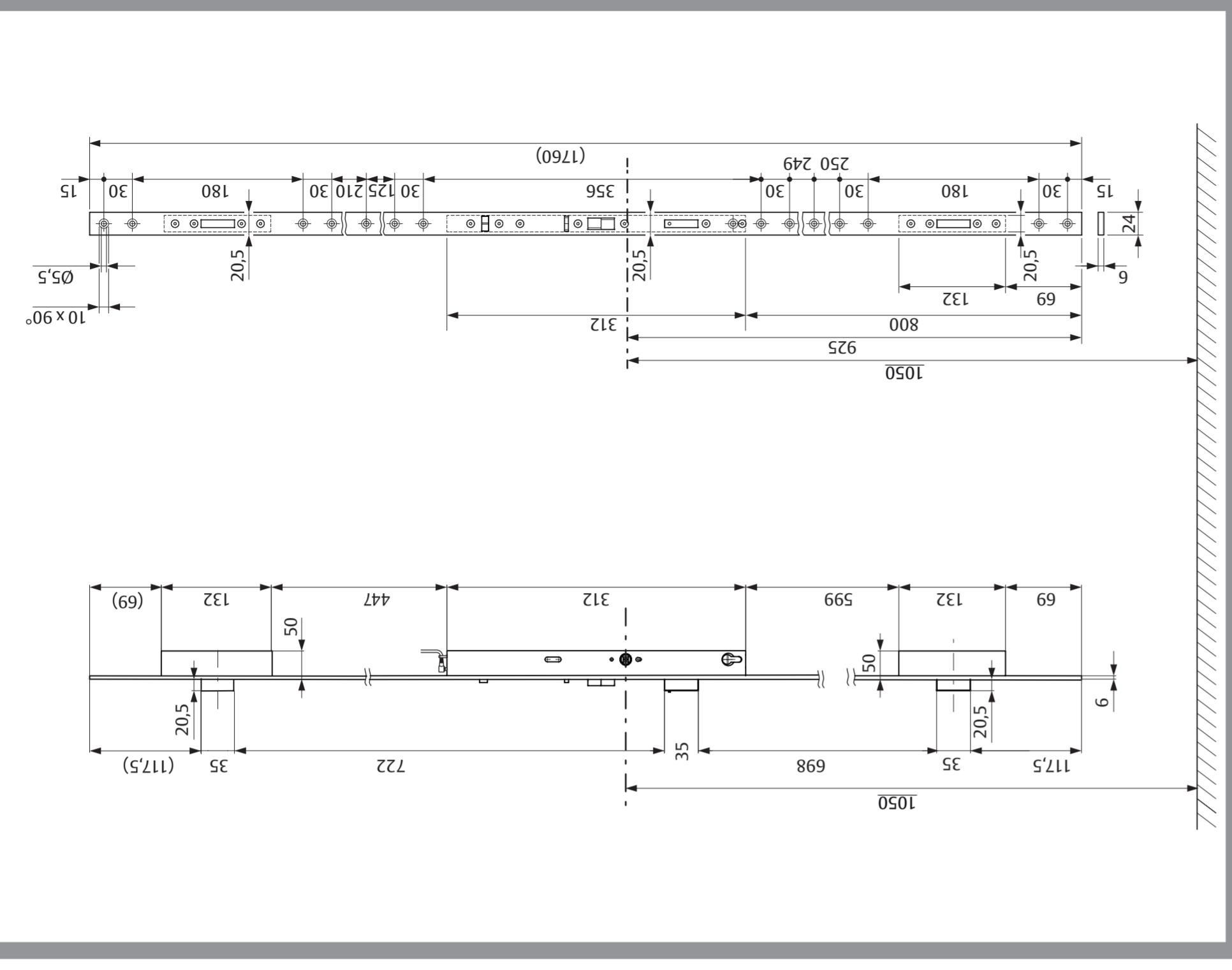
**Abmessungen des Elektro-Sicherheitsschlusses 809N / Dimensions of the electric security lock 809N / Dimensions de la serrure électrique de sécurité 809N / Dimensioni della serratura elettrica di sicurezza 809N / Afmetingen van het elektrische veiligheidssluit 809N / Abmessungen des Hauptschlusses 819N / Dimensions of main bolt 819N / Dimensions du pêne dormant principal 819N / Dimensioni serratura principale 819N / Afmetingen main slot 819N**
