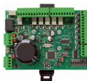
AWS ohne Gehäuse, auf Tragschienenadapter
