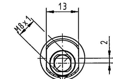
Maße für Durchbruch Anschluß für Schließhebel
