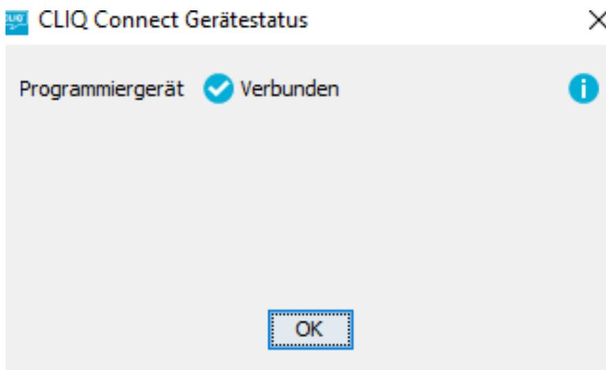
Bitte beachten Sie, dass CLIQ Connect PC nach der Installation automatisch mit Windows gestartet wird und den CLIQ Manager blockiert. CLIQ Connect PC muss beendet sein, damit man den CLIQ Manager vollumfänglich nutzen kann.
