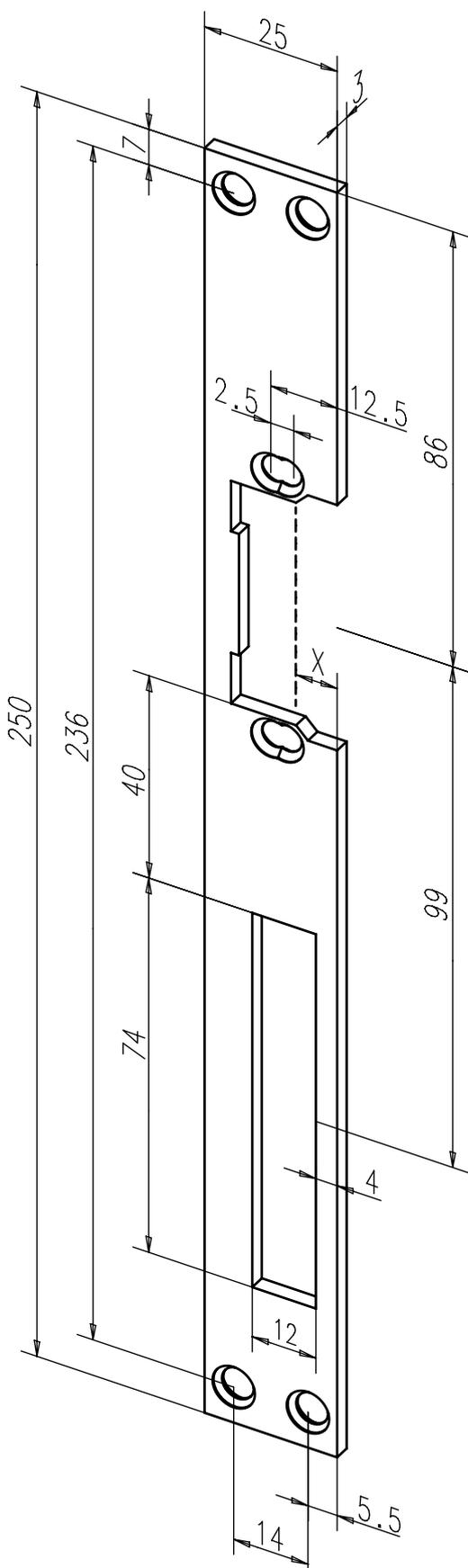
Flachschließblech mit Riegelausschnitt.
