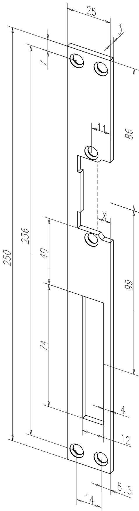
Flachschließblech mit Riegelausschnitt.
