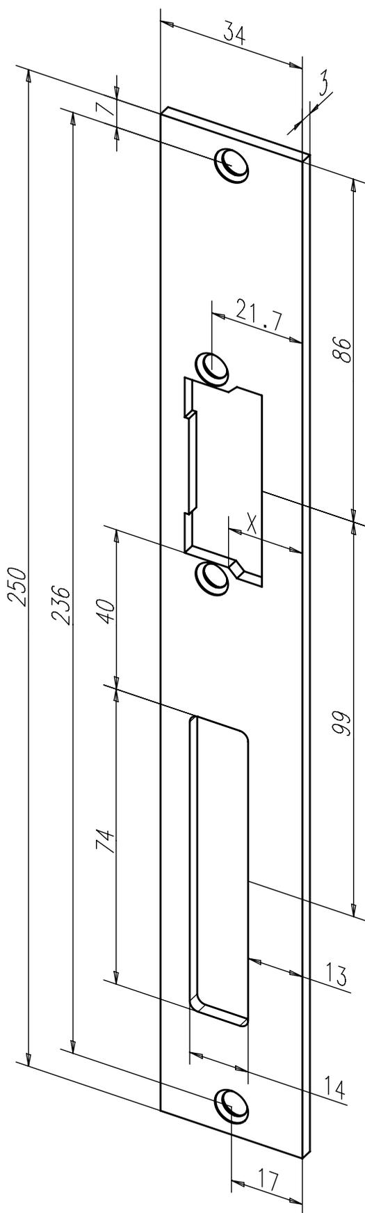
Flachschließblech mit Riegelausschnitt.
