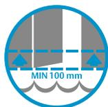
*Bei Montage in Fußbodennähe (Mindestabstand 100 mm) darauf achten, daß keine Bodenverunreinigungen und kein Schmutzwasser an den Türöffner gelangen.*
