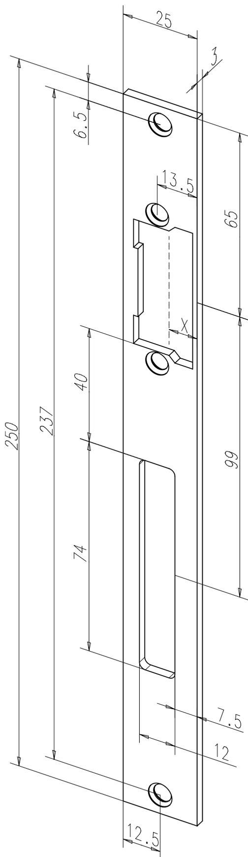
Flachschließblech mit Riegelausschnitt.
