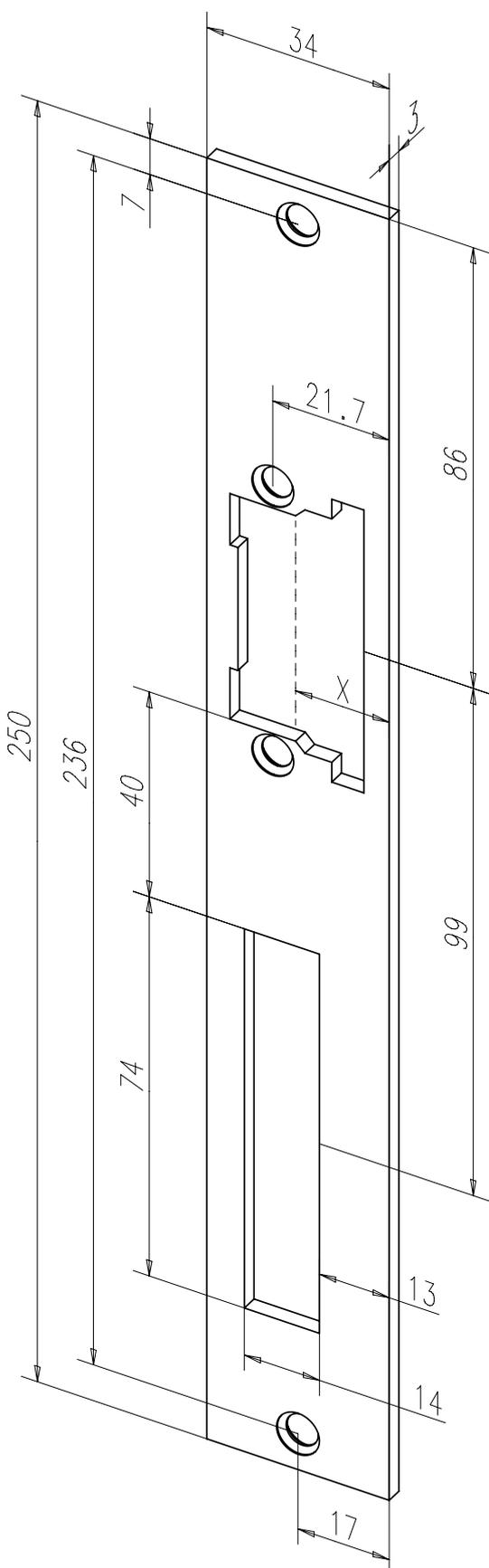
Lappenschließblech mit Riegelausschnitt.
