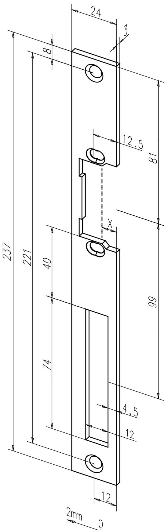
Flachschließblech mit Riegelausschnitt.
