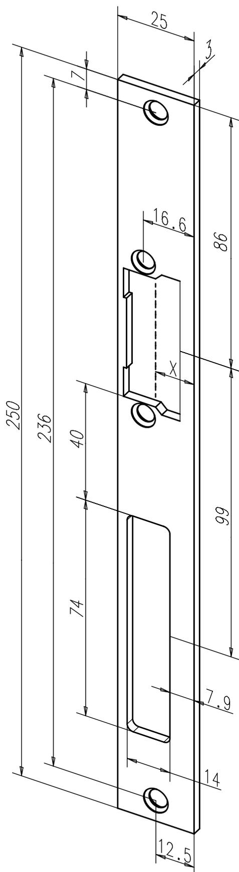
Flachschließblech mit Riegelausschnitt.
