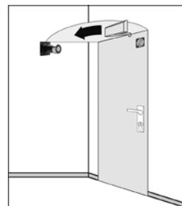
Der Türschließer wirkt oben, montieren Sie die Feststellanlage oben.
