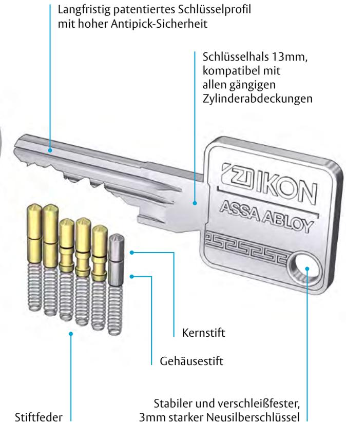
Langfristig patentiertes Schlüsselprofil mit hoher Antipick-Sicherheit
