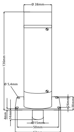
Türriegel als zusätzliche Verriegelung zum Hauptschloss. Die Türriegel sind für den Innenbereich konzipiert und im Türrahmen oben (senkrecht) zu montieren. Die Verriegelung erfolgt über einen 13 mm ausschließenden Sperrbolzen. Sie sind für Dreh- und Pendeltüren geeignet.
