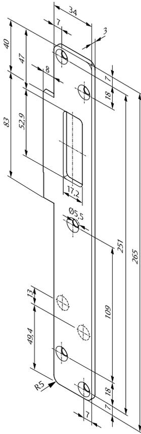
Lappenschließblech L4 Standard mit integrierten Magneten passend für Technilock® 844L4
