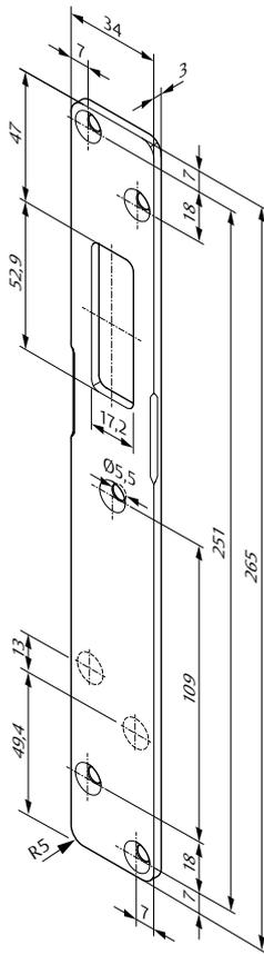
Schließblech L4 Standard mit integrierten Magneten passend für Technilock® L4
