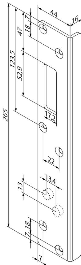
Winkelschließblech L4 mit integrierten Magneten passend für Technilock® 844L4
