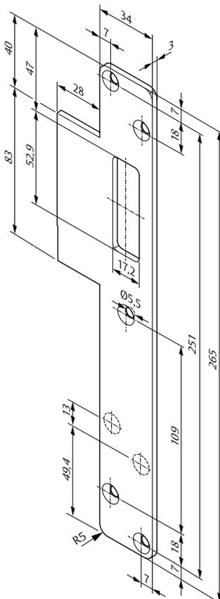
Lappenschließblech L4 Standard mit integrierten Magneten passend für Technilock® 844L4
