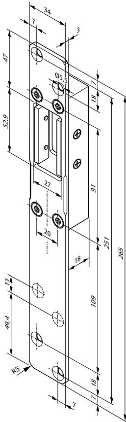
Schließblech L4 verstellbar mit integrierten Magneten passend für Technilock® L4
