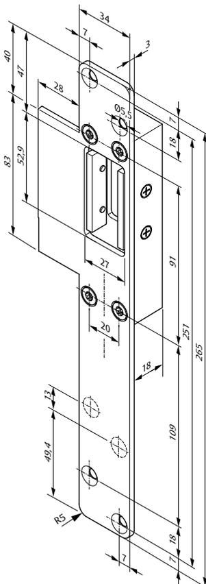
Lappenschließblech L4 verstellbar mit integrierten Magneten passend für Technilock® L4
