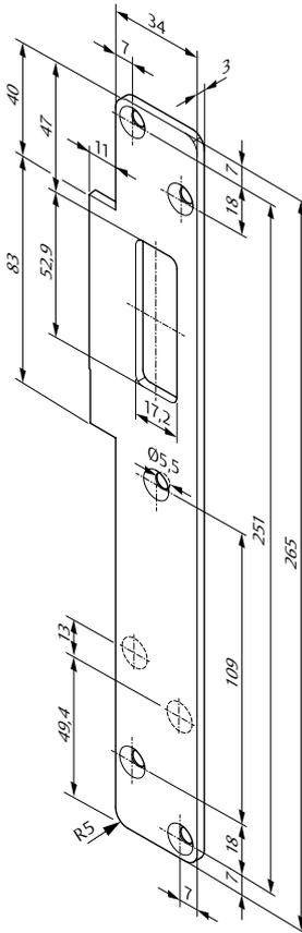
Lappenschließblech L4 Standard mit integrierten Magneten passend für Technilock® 844L4
