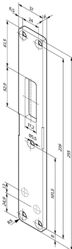
Schließblech L4 Standard mit integrierten Magneten passend für Technilock® 844L4, Abmessungen kompatibel zu Schließblech Technilock M4
