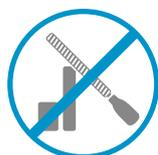
*Feil- und Schleifspäne werden magnetisch und verklemmen den Türöffneranker.*
