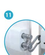
**11 IKON Protectorriegel** mit beidseitiger Verriegelung durch Doppelbolzen. Optional: mit oder ohne Sperrbügelfunktion, sowie ein- oder beidseitiger Vertikalverriegelung mit Riegelausschluss nach oben und in den Boden (alternativ für **4** und **7**)
