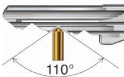
IKON-Schließzylinder sind auf eine lange Lebensdauer ausgelegt. Zum Beispiel durch die Flankenauflage von 110°, die eine minimale Abnutzung von Kernstiften und Schlüsseln gewährleistet.
