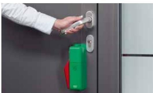
Eine Notöffnung der Tür ist jederzeit durch die Betätigung des Türdrückers möglich. Dabei wird der Überwachungshebel mit betätigt und ein akustischer Alarm ausgelöst, der nur durch den integrierten Schließzylinder zurückstellbar ist. Der Überwachungshebel schwenkt dabei nach unten und zeigt dadurch die Auslösung auch optisch an.
