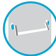
Die **Griffstange** ist die auslösende horizontale Betätigungsstange eines Paniktürverschlusses (Typ A). Sie wird zwischen zwei Schwenkarmen bzw. drehbaren Halterungen befestigt und in Fluchrichtung und / oder in einem nach unten gerichteten Bogen bewegt.
