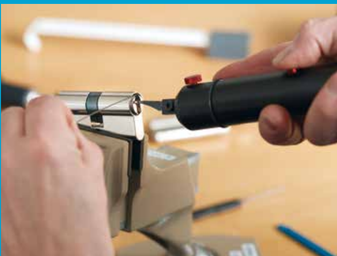
Versuch Lockpicking (Draht etc.): Eine manipulative Art des Öffnens, bei der nichts sichtbar zerstört wird, nennt man Lockpicking.
