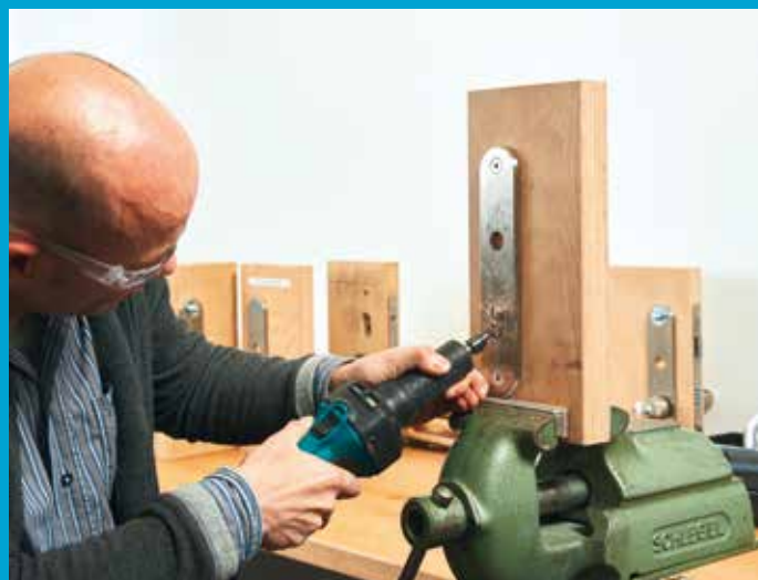
Versuch „Brute Force“-Öffnung: Unter gewaltsamem Öffnen versteht man z.B. Bohren, Schlagen oder Fräsen.
