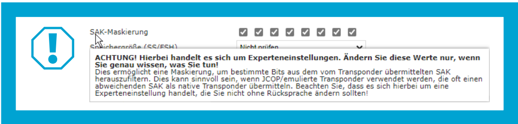
Abb. 27: Konfigurieren der Transpondertypen erfordert Expertenwissen
