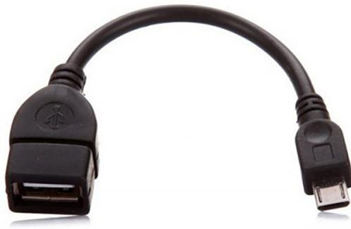
Abbildung 3. USB-OTG-Kabel
